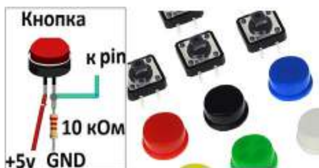
Рис. 1. Схема подключения тактовой кнопки к микроконтроллерной плате
