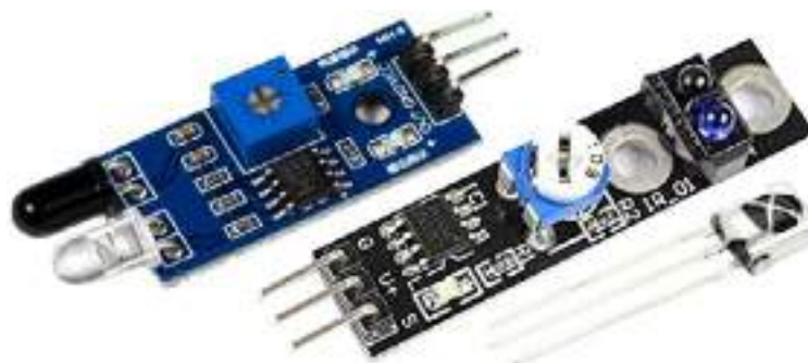
Рис. 15. Инфракрасный датчик (датчик линии)
