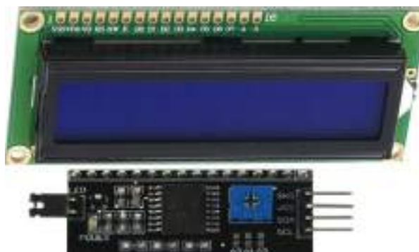
Рис. 17. Дисплей (жидкокристаллический индикатор — ЖКИ 16×2)
