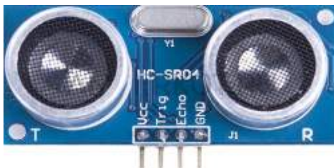
Рис. 16. Ультразвуковой датчик (дальномер)
